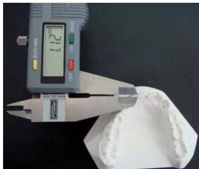
Figura 4 - Técnica de medição do índice de irregularidade.
